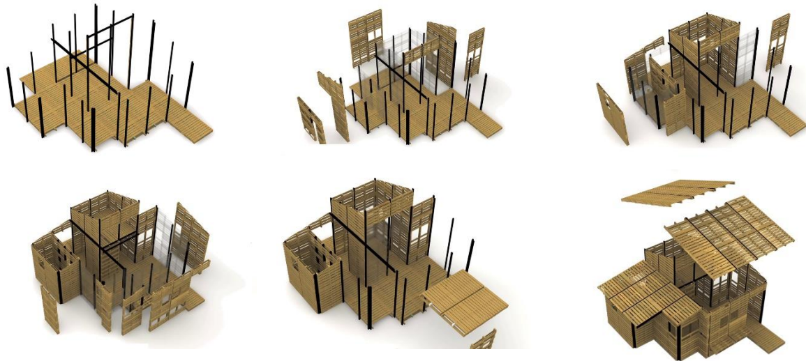
Figura 23 – Fases de montagem da Pallet House
